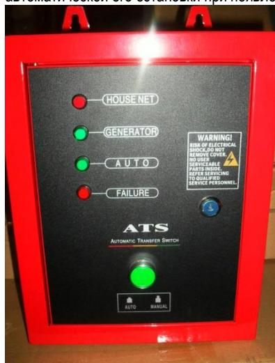
Установите блок ATS на стене. Подключите входящую основную сеть (рекомендуется через автомат защиты, в комплект поставки не входит) к блоку ATS. Проверьте, что мощность подходящей сети соответствует мощности ATS и мощности генератора. Если через ATS будет проходить ток более указанного на контакторах, это приведет к выходу блока ATS из строя (высокий риск короткого замыкания и возгорания по перегрузки). Монтаж блока ATS и его подключение доверяйте квалифицированному персоналу.
