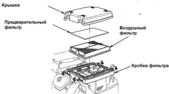
На моделях LDG 12 воздушный фильтр представляет собой разборную конструкцию, для прочистки необходимо промыть нижнюю часть фильтра (металлическую сетку) дизельным топливом, собрать фильтр.
