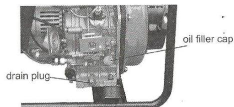
**Замена масла** - работы проводить на теплом двигателе, открутить спускной болт (пробку), слить отработанное масло, открыть заливную пробку, закрыть сливную пробку, залить свежее масла в двигатель. Проверить уровень масла по щупу, довести уровень масла до верхнего уровня по верхней метке щупа.
